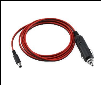
12V Kabel mit Hohlstecker mit Verpolungsschutz Kabellänge 3m, Hohlstecker 2.1/5.5mm innen = plus / aussen = minus
